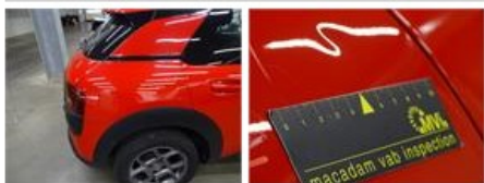
Door F R, Scratch(es), Acceptable
