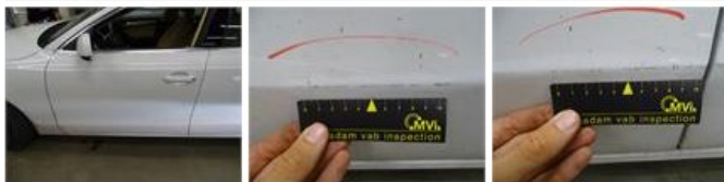
Door F R, Scratch(es), Acceptable
