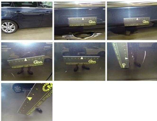
Door F R, Scratch(es), Acceptable
