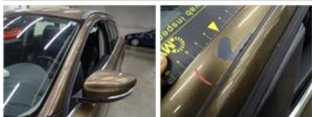
Door F R, Scratch(es), Acceptable
