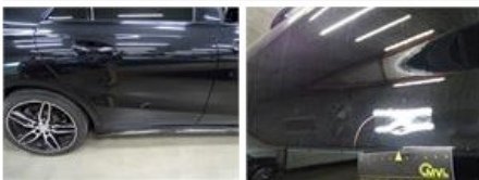
Door F R, Scratch(es), Acceptable
