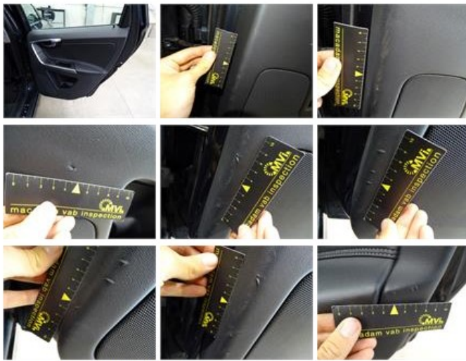
Door R R, Scratch(es), Acceptable
