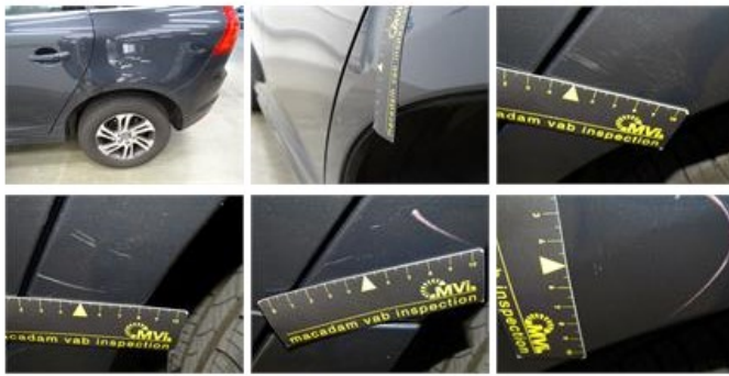
Door panel R R, Tear, E - Replace
