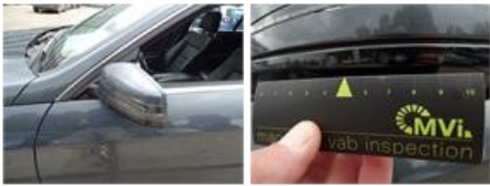
Door frame R R, Scratch(es), Acceptable
