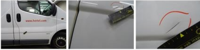
Door trim R R, Scratch(es), E - Replace
