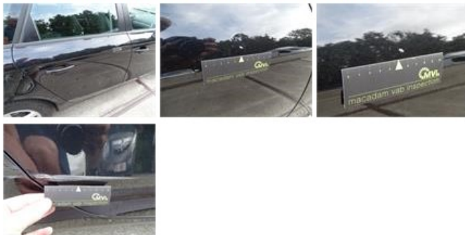
Door F R, Scratch(es), Acceptable
