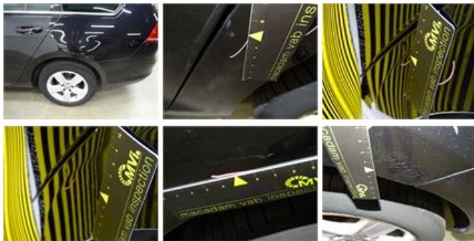
Door R R, Scratch(es), Acceptable
