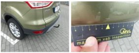
Door R R, Scratch(es), Acceptable
