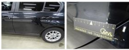
Door R R, Scratch(es), Acceptable
