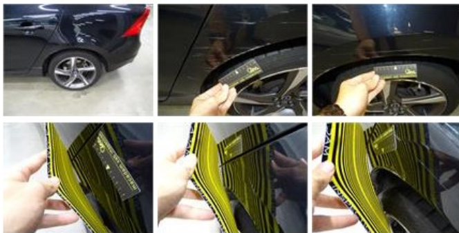
Door R R, Scratch(es), Acceptable
