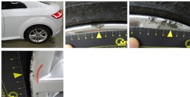
Alloy rim R L, Scratch(es), E - Replace
