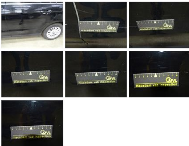
Door R R, Scratch(es), Acceptable
