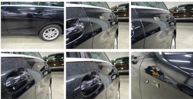
Door F R, Scratch(es), Acceptable 0,00
