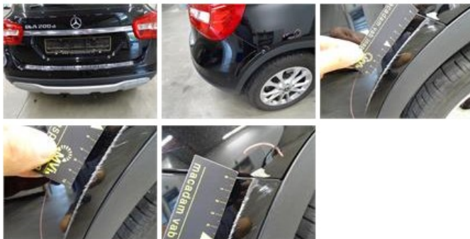
Door F R, Scratch(es), Acceptable
