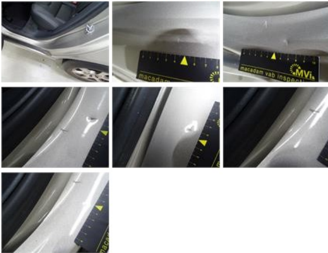
Door panel R R, Tear, E - Replace
