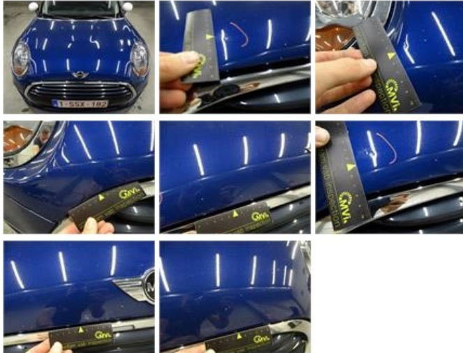
Door F R, Scratch(es), Acceptable
