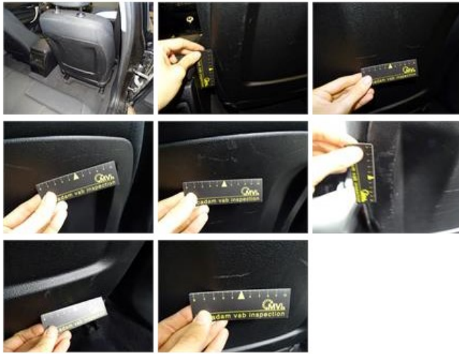
Door R R, Scratch(es), Acceptable
