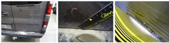
Door R R, Scratch(es), Acceptable
