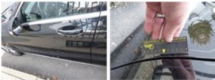
Door R R, Scratch(es), Acceptable
