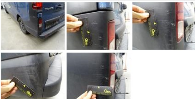
Door moulding Lower R R, Scratch(es), E - Replace
