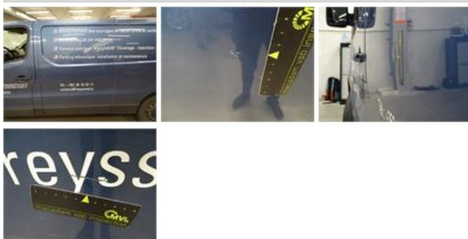
Door R R, Scratch(es), Acceptable
