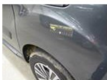
Sill outer R, Scratch(es), E - Replace
