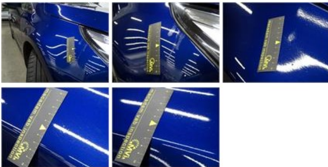
Door R R, Bad repair, P - Check
