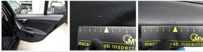
Door R R, Scratch(es), Acceptable
