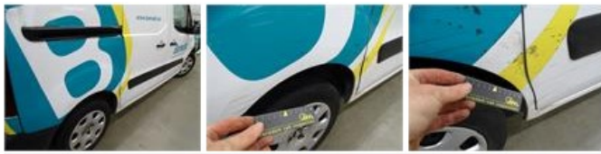
Door moulding Lower R R, Scratch(es), E - Replace
