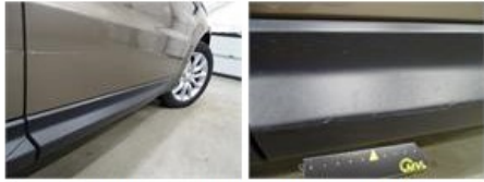
Door moulding Lower R R, Crack, E - Replace
