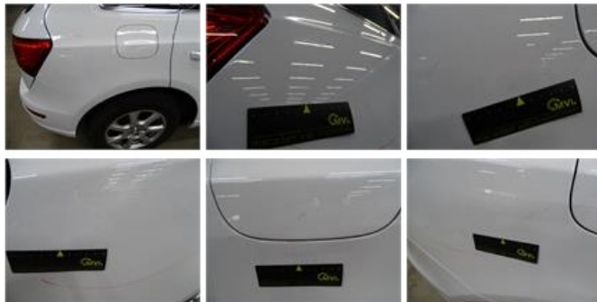
Door F R, Scratch(es), Acceptable
