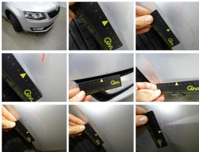
Door R R, Scratch(es), Acceptable
