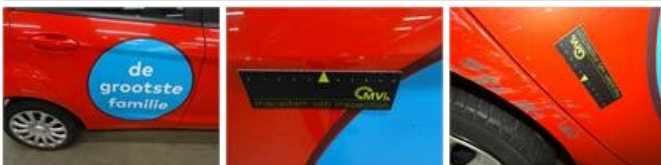
Door F R, Scratch(es), Acceptable
