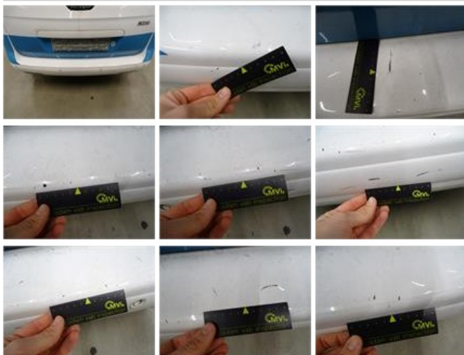
Door R R, Scratch(es), Acceptable
