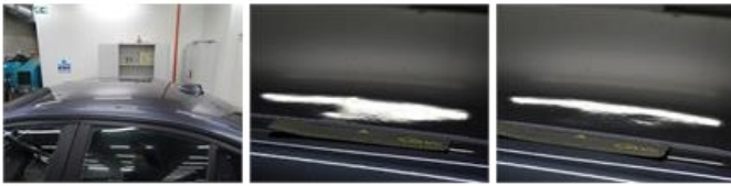
Door panel F L, Tear, E - Replace
