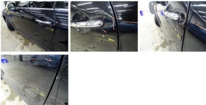
Wing trim R L, Scratch(es), E - Replace
