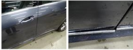
Door R R, Scratch(es), Acceptable
