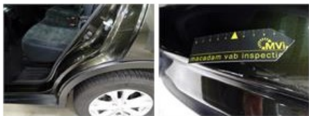
Door panel F L, Tear, E - Replace
