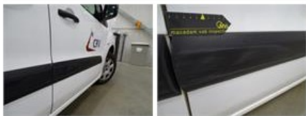
Door trim R R, Scratch(es), E - Replace
