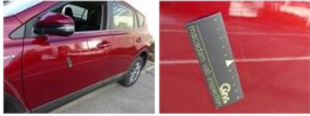
Door R R, Scratch(es), Acceptable
