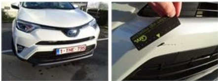
Wing trim R L, Scratch(es), E - Replace
