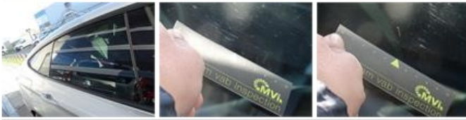
Door window RL, Scratch(es), E - Replace
