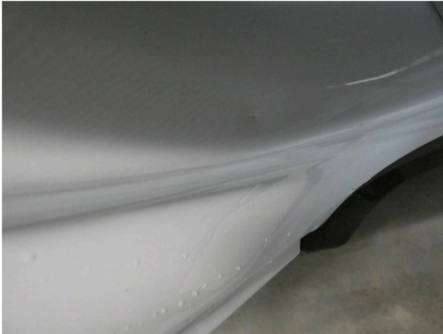
Bild 29 Innenraum Einstieg hi. re. Dellen und Kratzer
