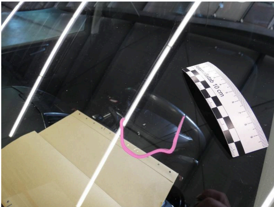
Bild 24 Fahrzeugfront Frontscheibe oberflächliche Steinschlag / -schläge
