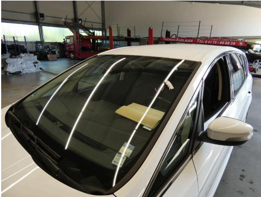
Bild 23 Fahrzeugfront Frontscheibe oberflächliche Steinschlag / -schläge
