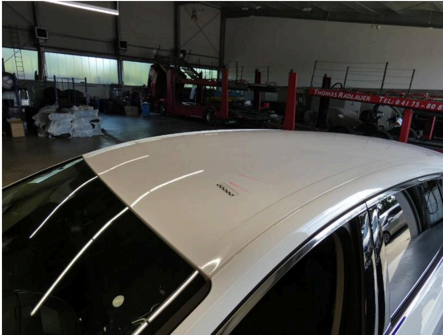
Bild 41 Dach Dachhaut verkratzt
