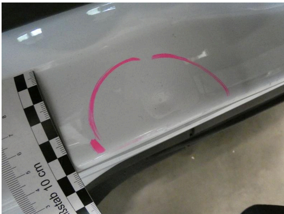
Bild 28 Innenraum Einstieg hi. re. Dellen und Kratzer
