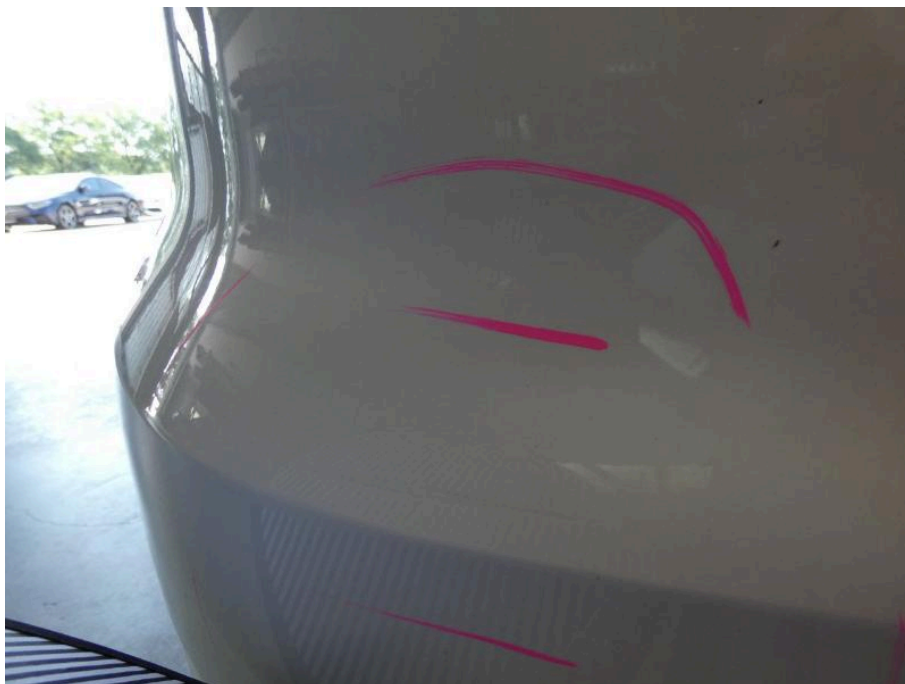
Bild 33 Fahrzeugheck Stoßfänger (hinten) verformt
