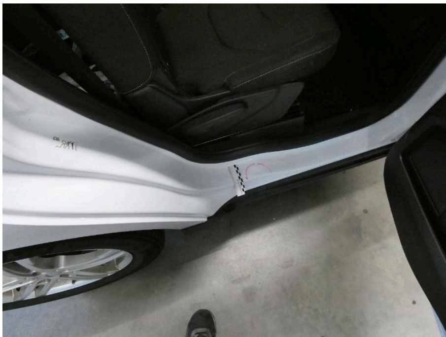
Bild 27 Innenraum Einstieg hi. re. Dellen und Kratzer
