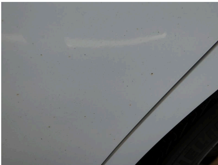
Bild 40 Fahrzeug Gesamtes Fahrzeug leichten Flugrost auf Lack
