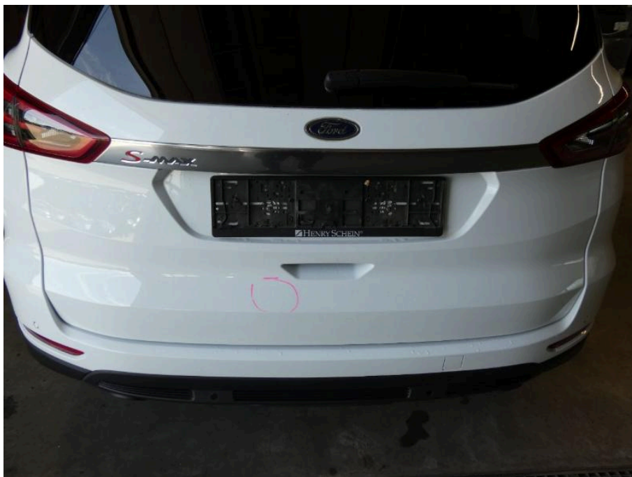
Bild 35 Fahrzeugheck Kofferdeckel / Heckklappe Verkleidung aussen Delle
