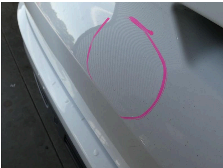
Bild 36 Fahrzeugheck Kofferdeckel / Heckklappe Verkleidung aussen Delle
