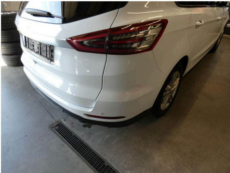
Bild 30 Fahrzeugheck Stoßfänger (hinten) verformt
