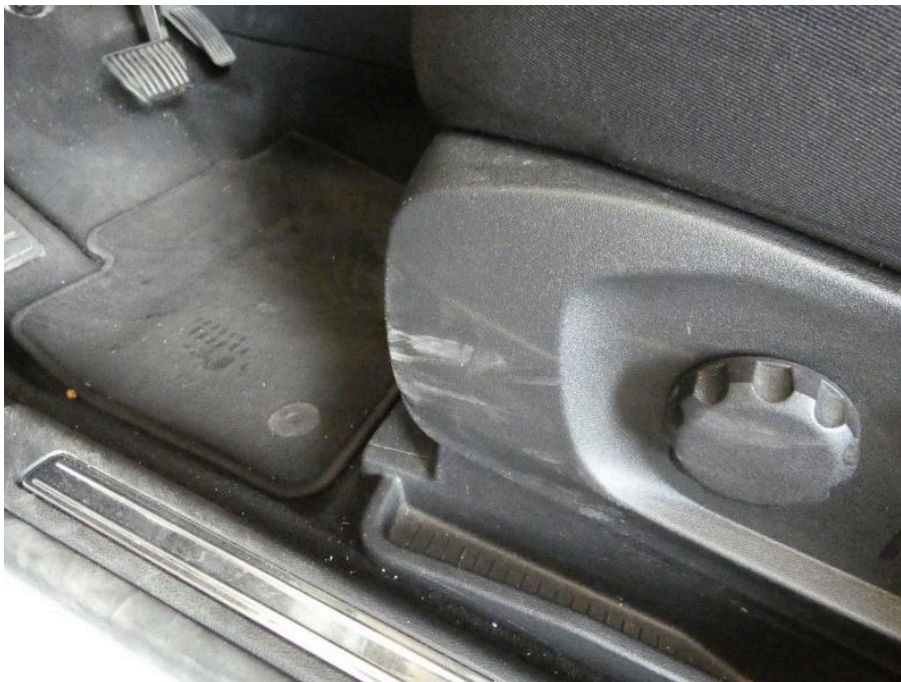
Bild 18 Innenraum Innenraum Oberflächige Kratzer und verschmutzt
