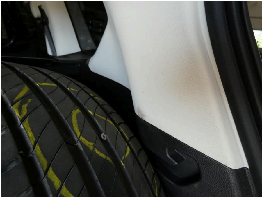
Bild 46 Innenraum Innenraum Oberflächige Kratzer und verschmutzt
