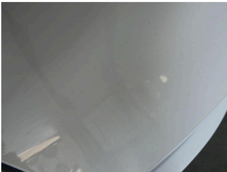
Bild 38 Fahrzeug Gesamtes Fahrzeug leichten Flugrost auf Lack
