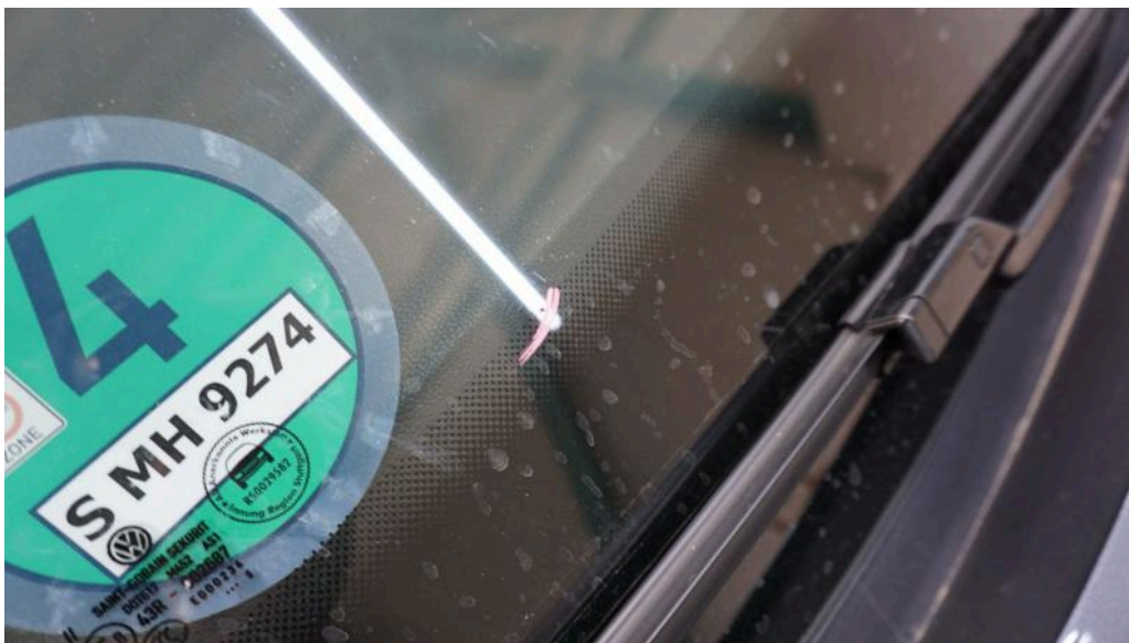
Bild 18 Fahrzeugfront Frontscheibe Steinschlag / -schläge
