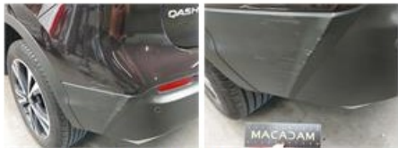
Door RR, Scratch(es), Acceptable
