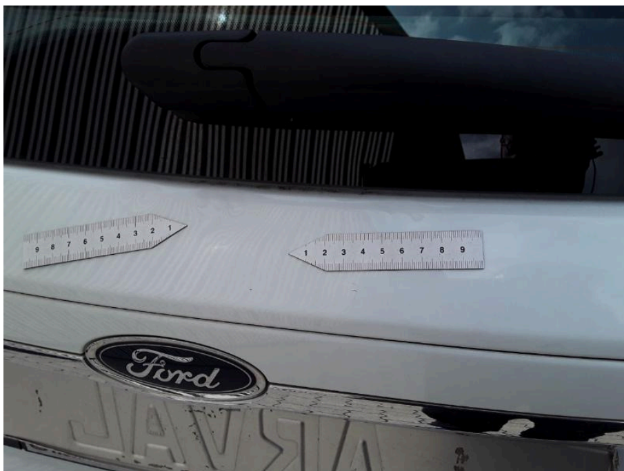
Bild 28 Fahrzeugheck Kofferdeckel / Heckklappe Dellen
