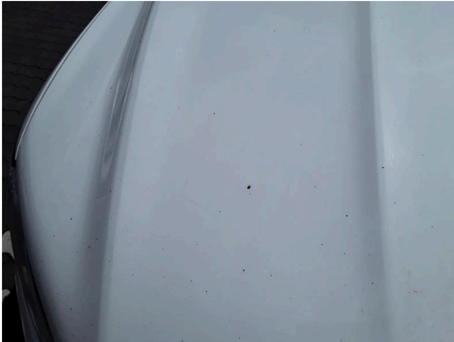
Bild 23 Fahrzeugfront Motorhaube Steinschlag / -schläge
