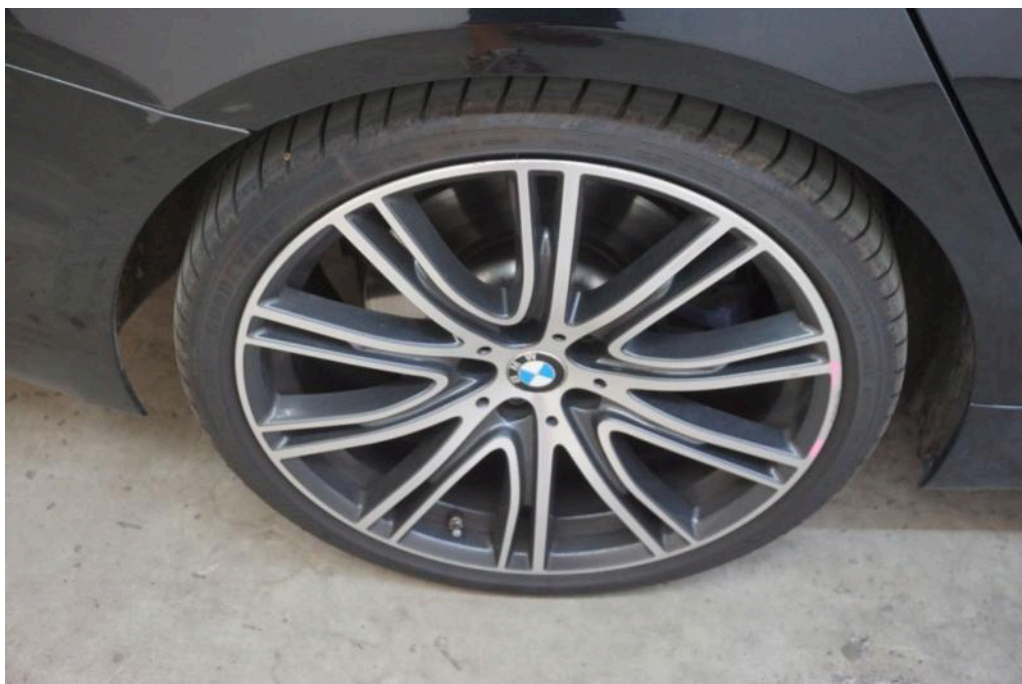
Bild 26 Hinterachse Felge rechts (hinten) Materialabtrag
