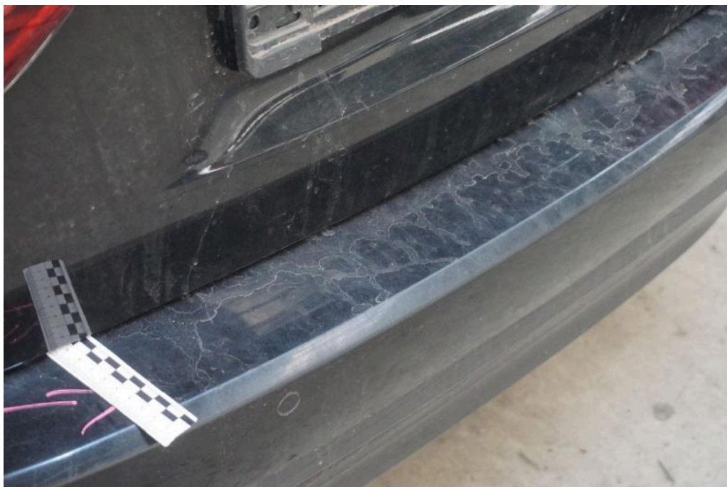
Bild 25 Fahrzeugheck Stoßfänger (hinten) Kratzer
