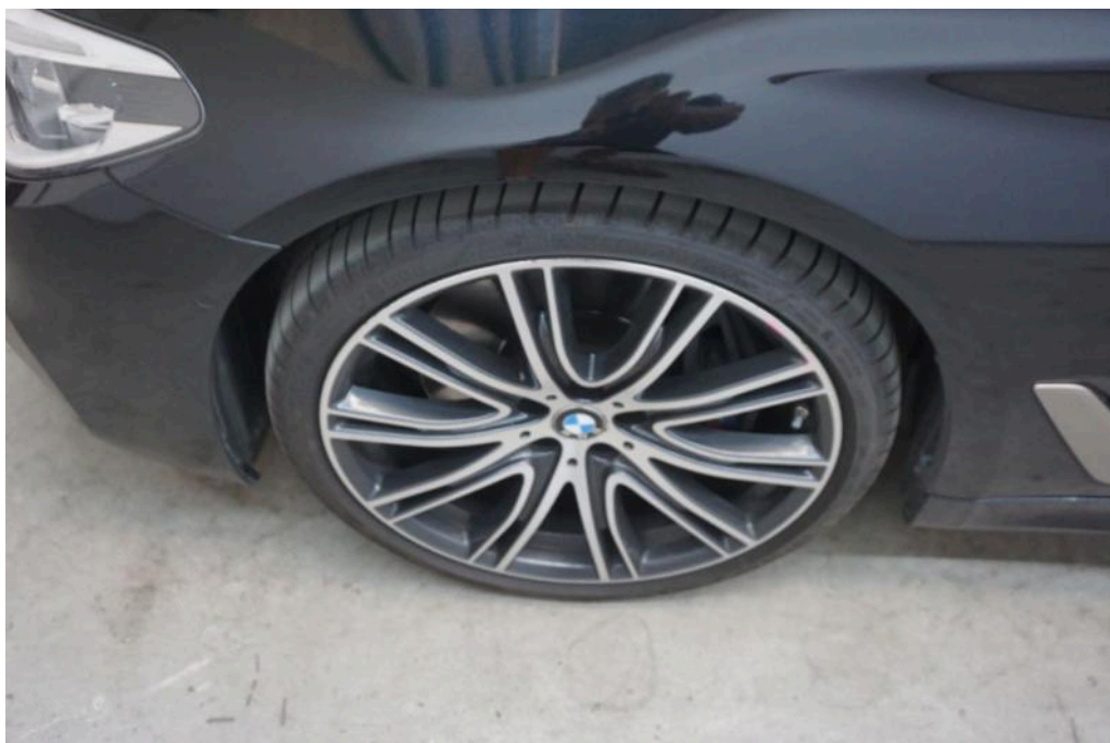
Bild 22 Vorderachse Felge links (vorne) Kratzer
