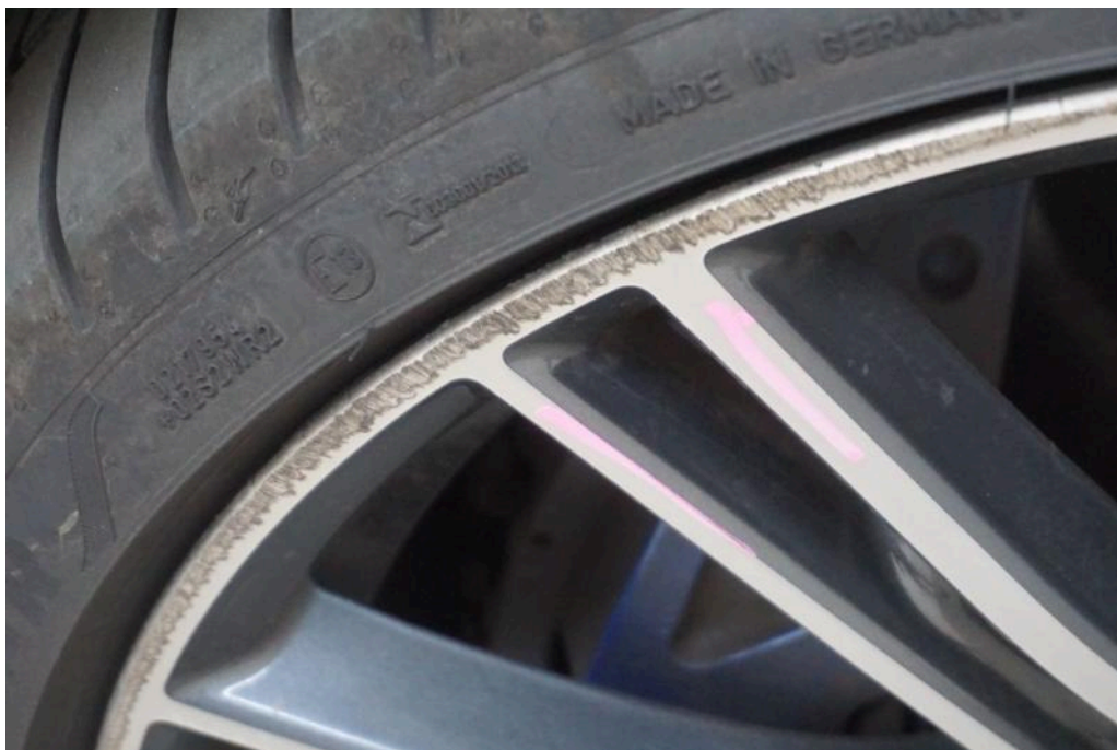
Bild 29 Vorderachse Felge rechts (vorne) Materialabtrag
