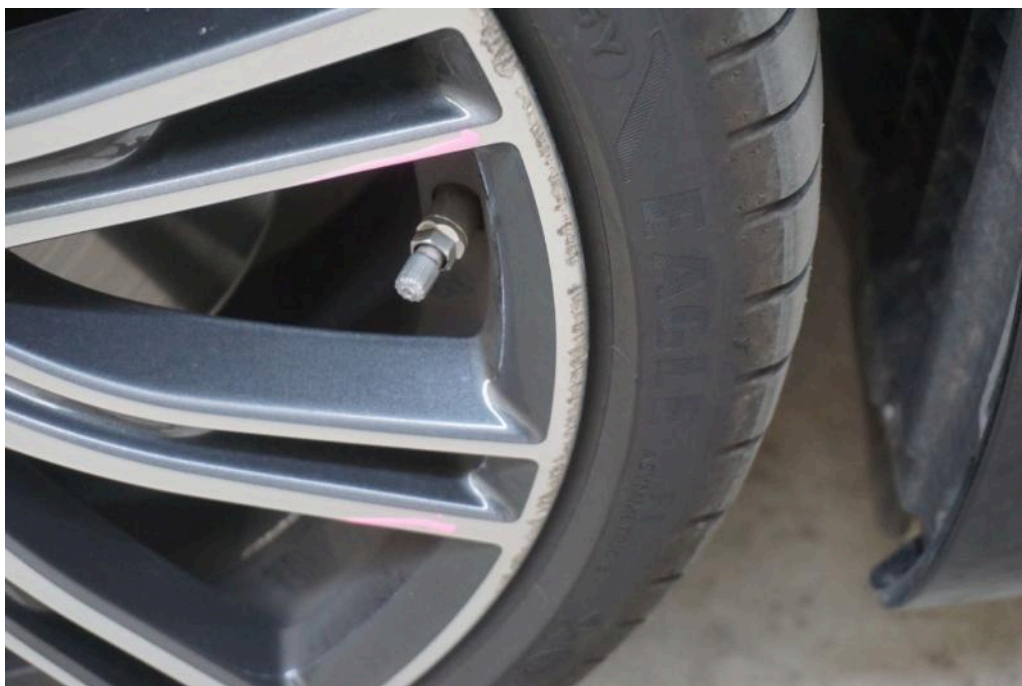
Bild 30 Vorderachse Felge rechts (vorne) Materialabtrag
