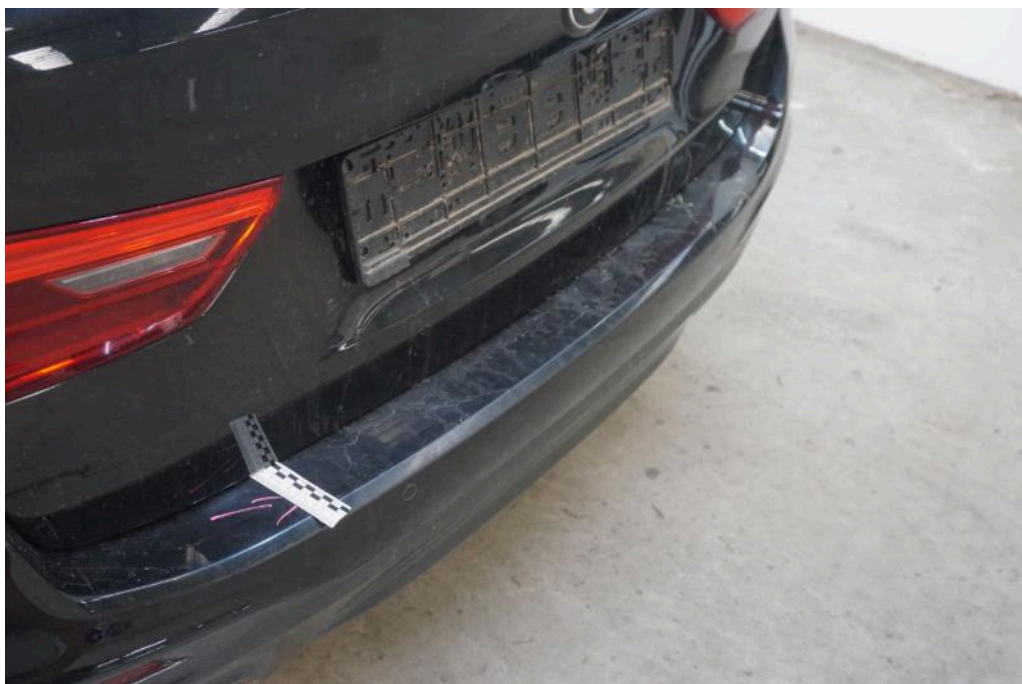
Bild 24 Fahrzeugheck Stoßfänger (hinten) Kratzer
