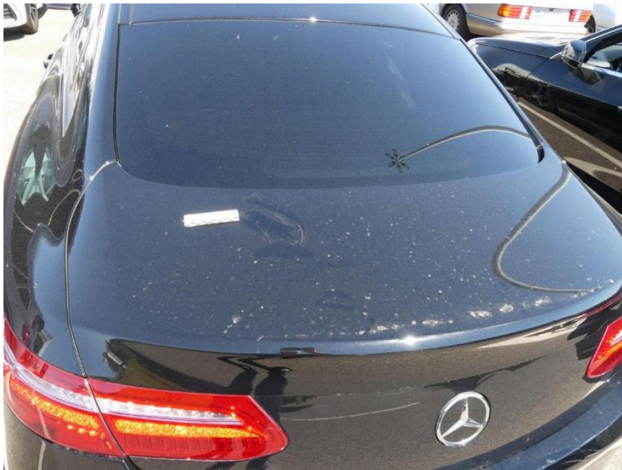
Bild 18 Fahrzeugheck Heckklappe verkratzt, schleifen und polieren, Kostenausweitung möglich
