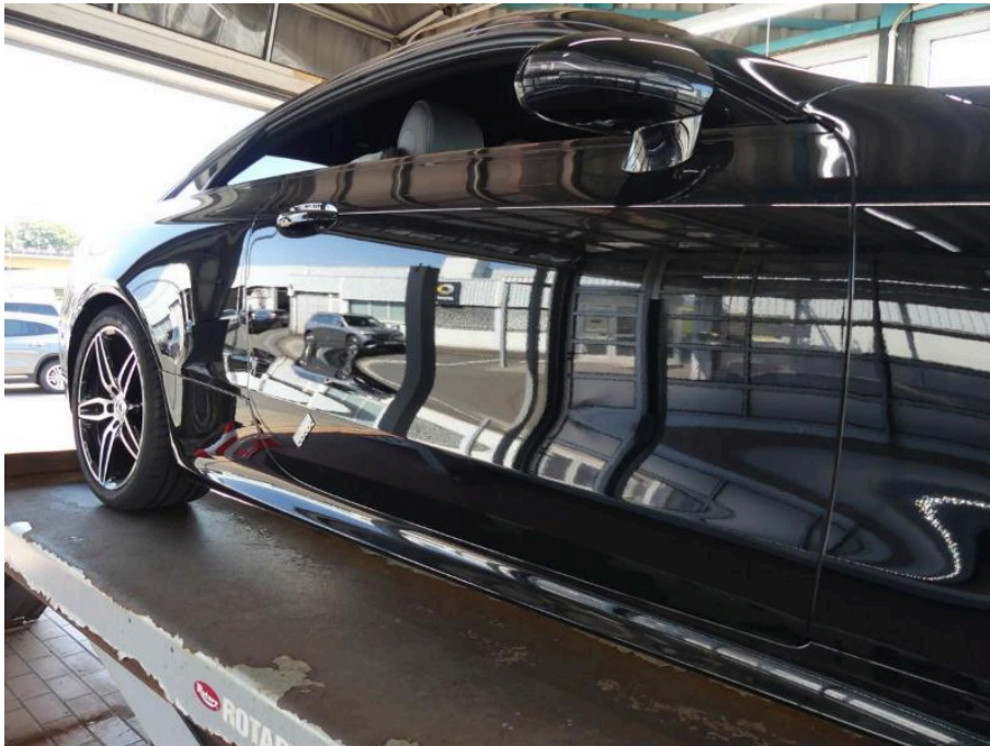
Bild 34 rechte Seite Tür vorne rechts verformt
