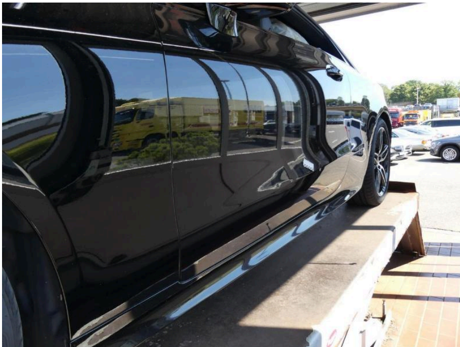
Bild 30 linke Seite Tür vorne links verformt
