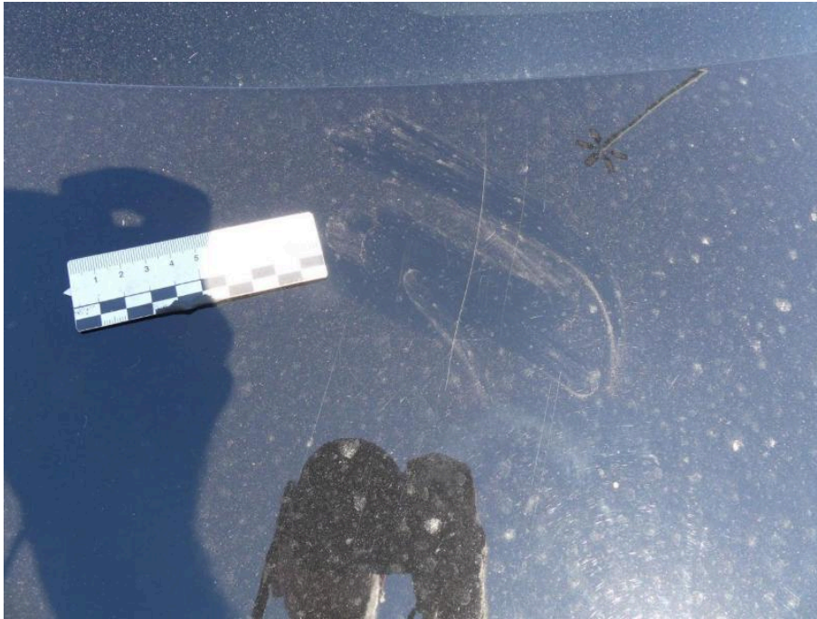
Bild 19 Fahrzeugheck Heckklappe verkratzt, schleifen und polieren, Kostenausweitung möglich
