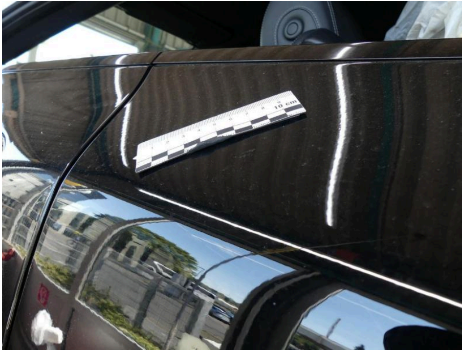
Bild 37 rechte Seite Tür vorne rechts verformt
