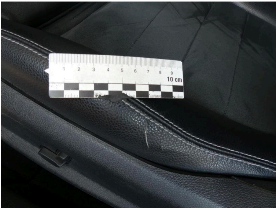
Bild 44 Innenraum Fahrersitzbezug gerissen
