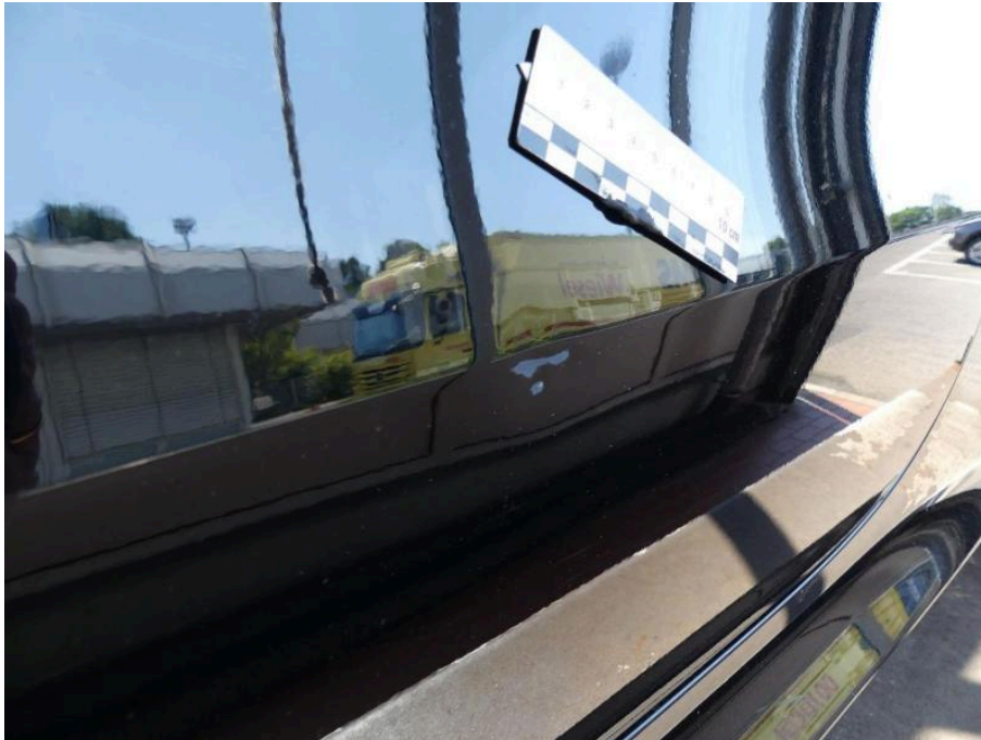
Bild 31 linke Seite Tür vorne links verformt
