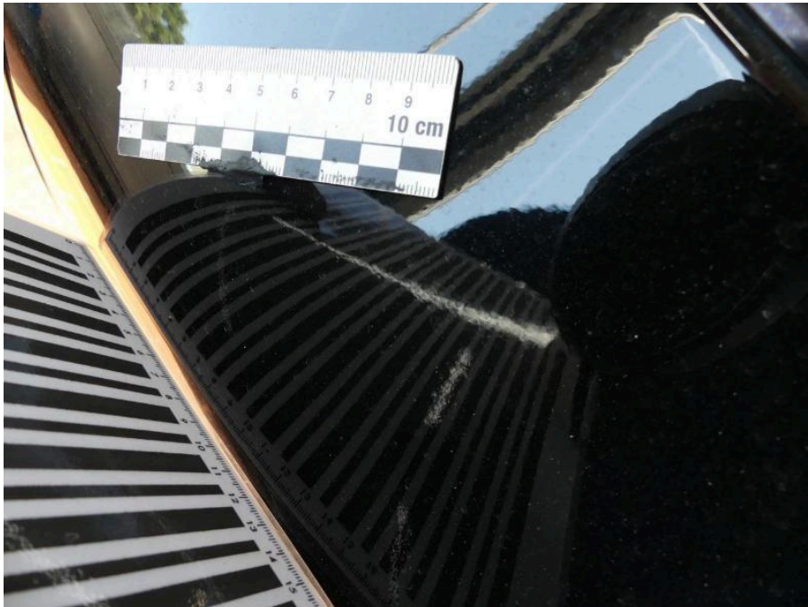
Bild 26 linke Seite Seitenwand links Delle
