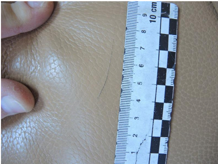
Bild 26 Innenraum Sitz vorn links Lehnenbezug /Sitzfläche gerissen / eingerissen
