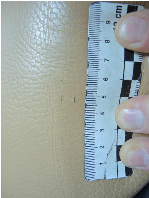
Bild 24 Innenraum Sitz vorn links Lehnenbezug /Sitzfläche gerissen / eingerissen
