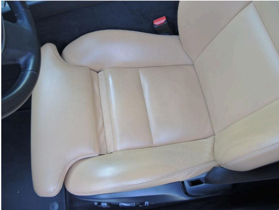
Bild 25 Innenraum Sitz vorn links Lehnenbezug /Sitzfläche gerissen / eingerissen
