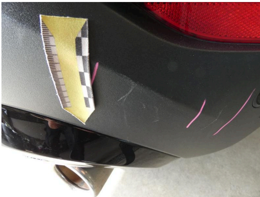
Bild 39 Fahrzeugheck Stoßfänger (hinten) Unterteil verkratzt
