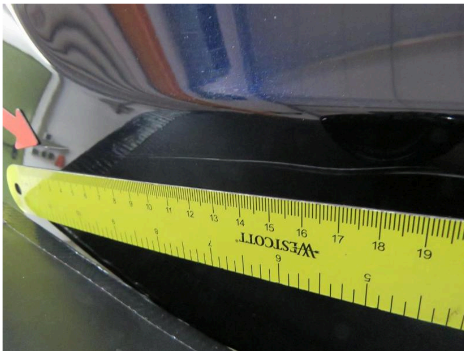
Bild 35 Fahrzeugheck Kofferdeckel / Heckklappe verkratzt
