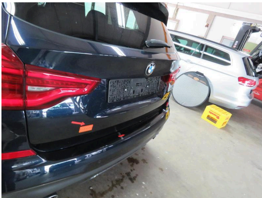
Bild 32 Fahrzeugheck Kofferdeckel / Heckklappe verkratzt
