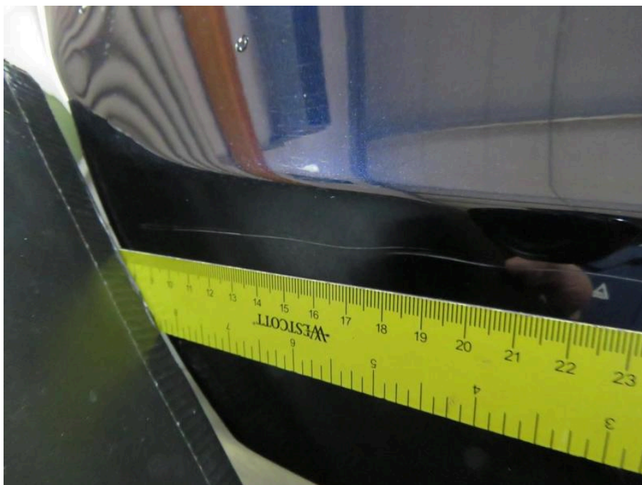
Bild 34 Fahrzeugheck Kofferdeckel / Heckklappe verkratzt
