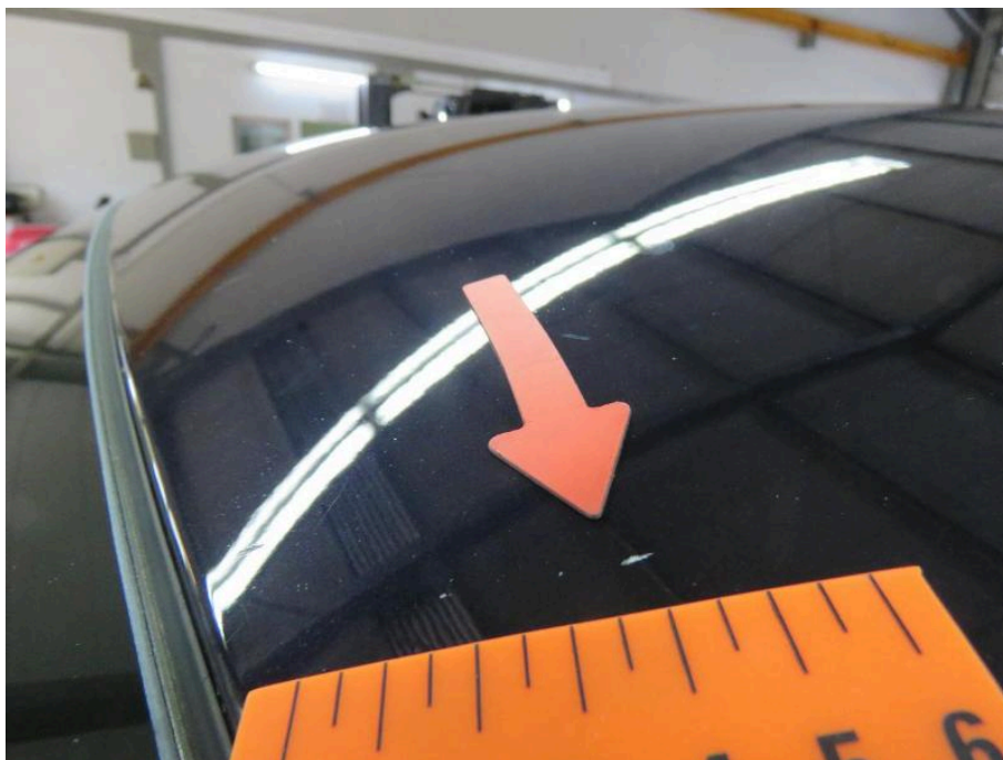
Bild 37 Dach Dachhaut Steinschlag / -schläge
