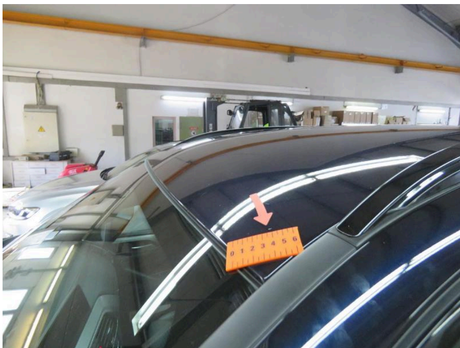
Bild 36 Dach Dachhaut Steinschlag / -schläge
