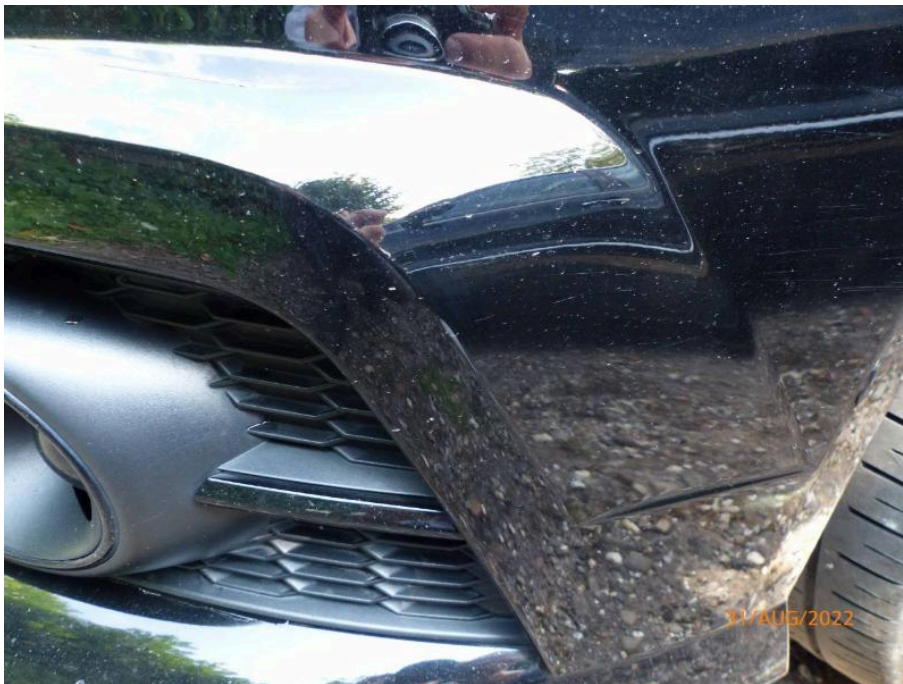
Bild 24 Fahrzeugfront Stoßfänger Stoßfängerverkleidung vorn links leicht verschürft verschürft
