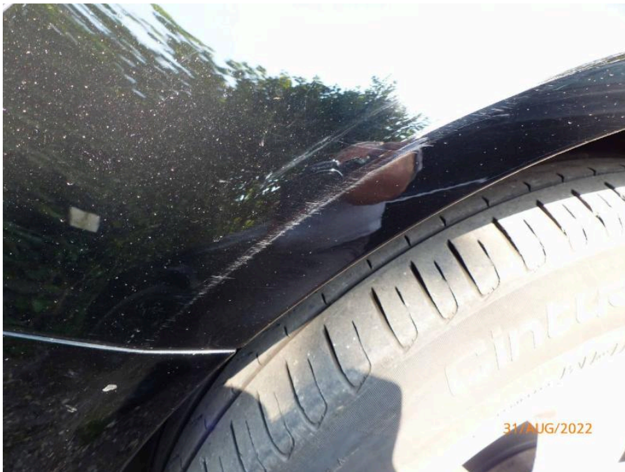
Bild 26 linke Seite Kotflügel links Kotflügel / Radlauf vorn links verschürft verschürft
