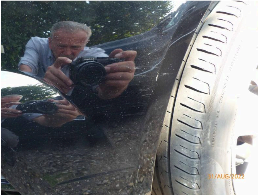
Bild 25 Fahrzeugfront Stoßfänger Stoßfängerverkleidung vorn links leicht verschürft verschürft
